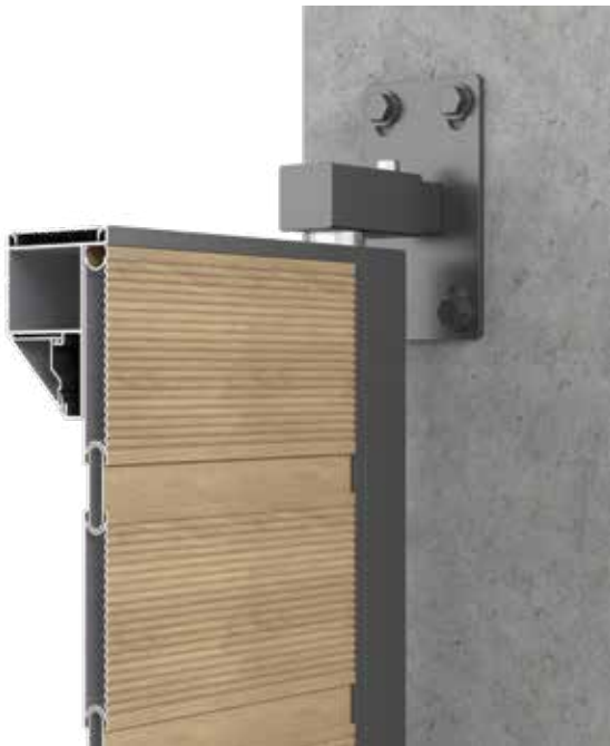
Vistas de detalle, superior e inferior, de los marcos y perfiles ranurados, así como perfil del eje de pivote con ACERO INOXIDABLE 316 GOND que soporta 250 Kg cada uno. El marco máximo de la puerta de una hoja está cerca de los 4 m 2 y soporta una carga de viento máxima de 2KPa.
